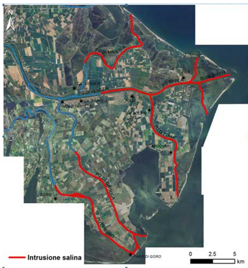
Fig. 39: Risalita del cuneo salino lungo i rami deltizi – Campagna di misure del Luglio 2017 (Arpa) – la zona d'intervento è posta diversi chilometri più a monte.
