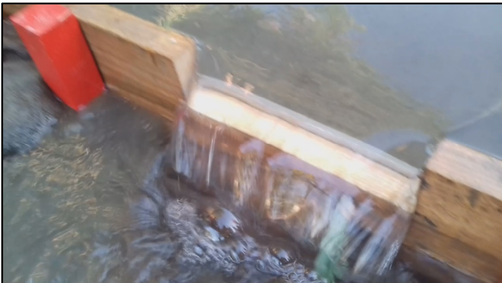
Figg. 7 e 8: Particolare del punto di uscita della tubazione di scarico del drenaggio e dello stramazzo a parete sottile o di Bazin realizzato per la misura di portata in data 03.12.2019 - località Cavanella Po.
